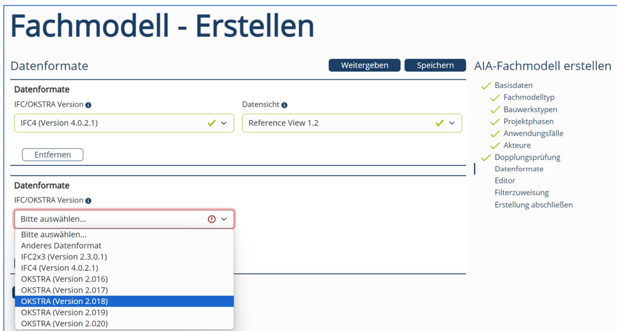
Abbildung 18: Dialog zur Erstellung einer Fachmodells, hier: Auswahl der zu unterstützenden Datenformate und der entsprechenden Datensicht, eine Mehrfachauswahl ist möglich
